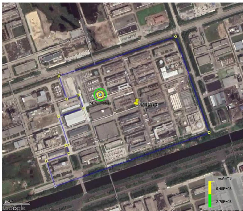
图 6.10.5-3 最常见气象条件下火灾爆炸伴生/次生甲醇排放预测结果
